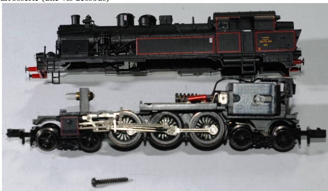
Déclipser le support d'alimentation de la lampe arrière et retirer le moteur (deux vis)
