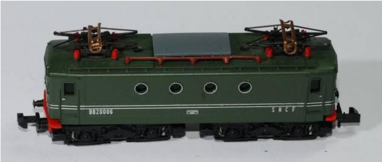
Démonter la carrosserie (deux vis sur le toit). Laisser la platine en place
